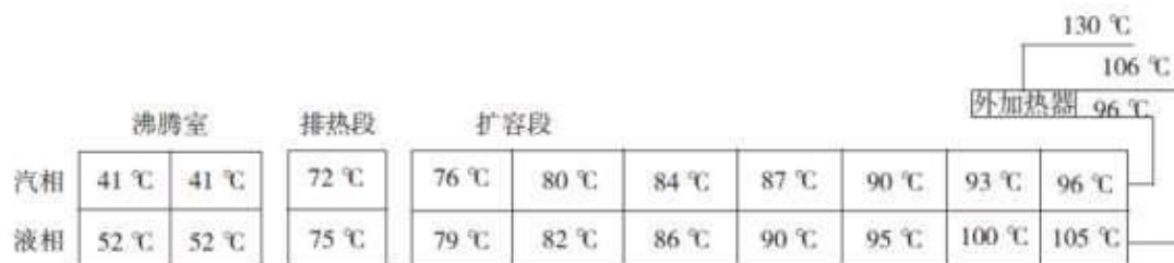
图 6.2-3 蒸发器各段温度分布图
